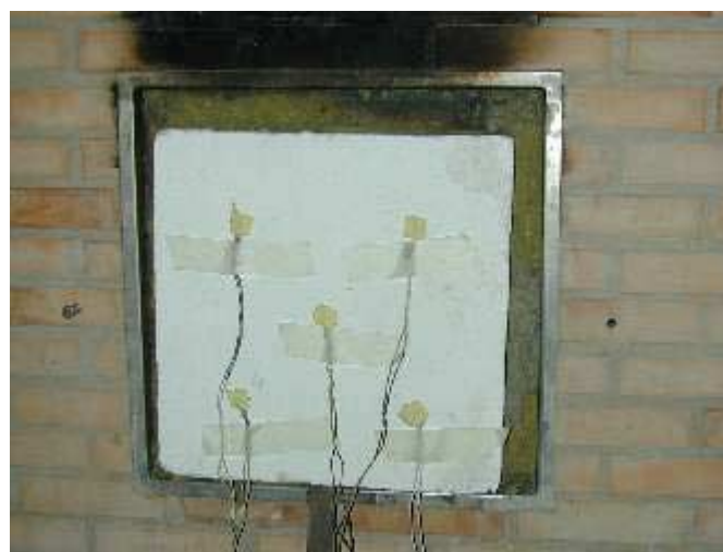
Abbildung 27: Brandversuch mit Kleinprobe – Außenwand mit Temperaturmessfühlern
