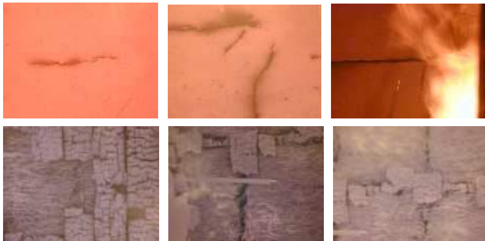
Abbildung 29: Lehmverputzte Innenseite des Strohwandaufbaus beim Brandversuch
