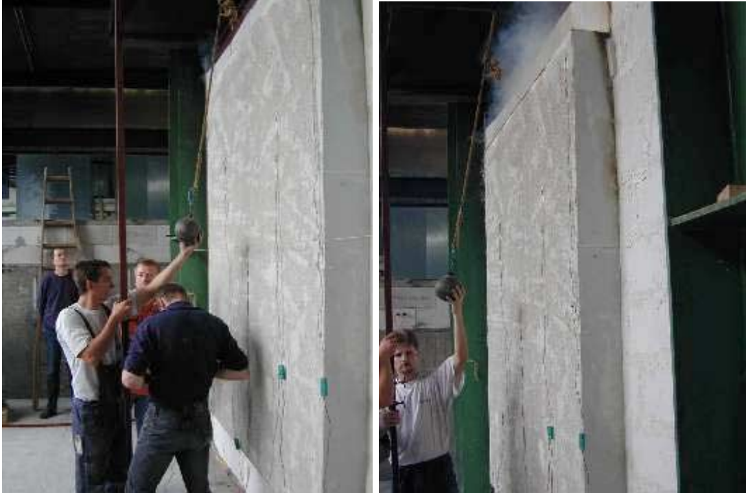
Abbildung 31: Vorbereitungen für den Schlagversuch im Rahmen der Bauteilüberprüfung
