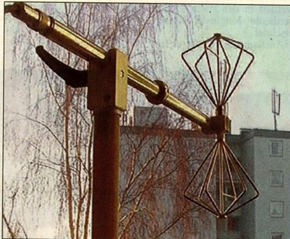
Mit einer solchen bikonischen Messantenne ermittelt die Stadt die Strahlungswerte rund um das Hochhaus.
