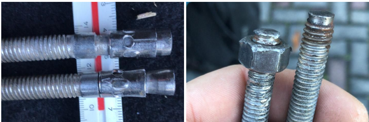
Dois parabolts escurecidos retirados da via Alibabá roubou o crux. Nota-se a diferença de modelo dos dois parabolts pelo espaço entre a rosca e o início do espaço da jaqueta.
